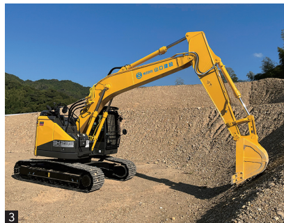
1.現場事務所では進んで意見を出し合って綿密に打ち合わせ 2.自動追尾測量機器による測量作業 3.マシンガイダンス(ICT施工対応)型の自社バックホーを駆使して生産性を向上 4.内外装をリノベーションし、より居心地よくなった井田営業所
